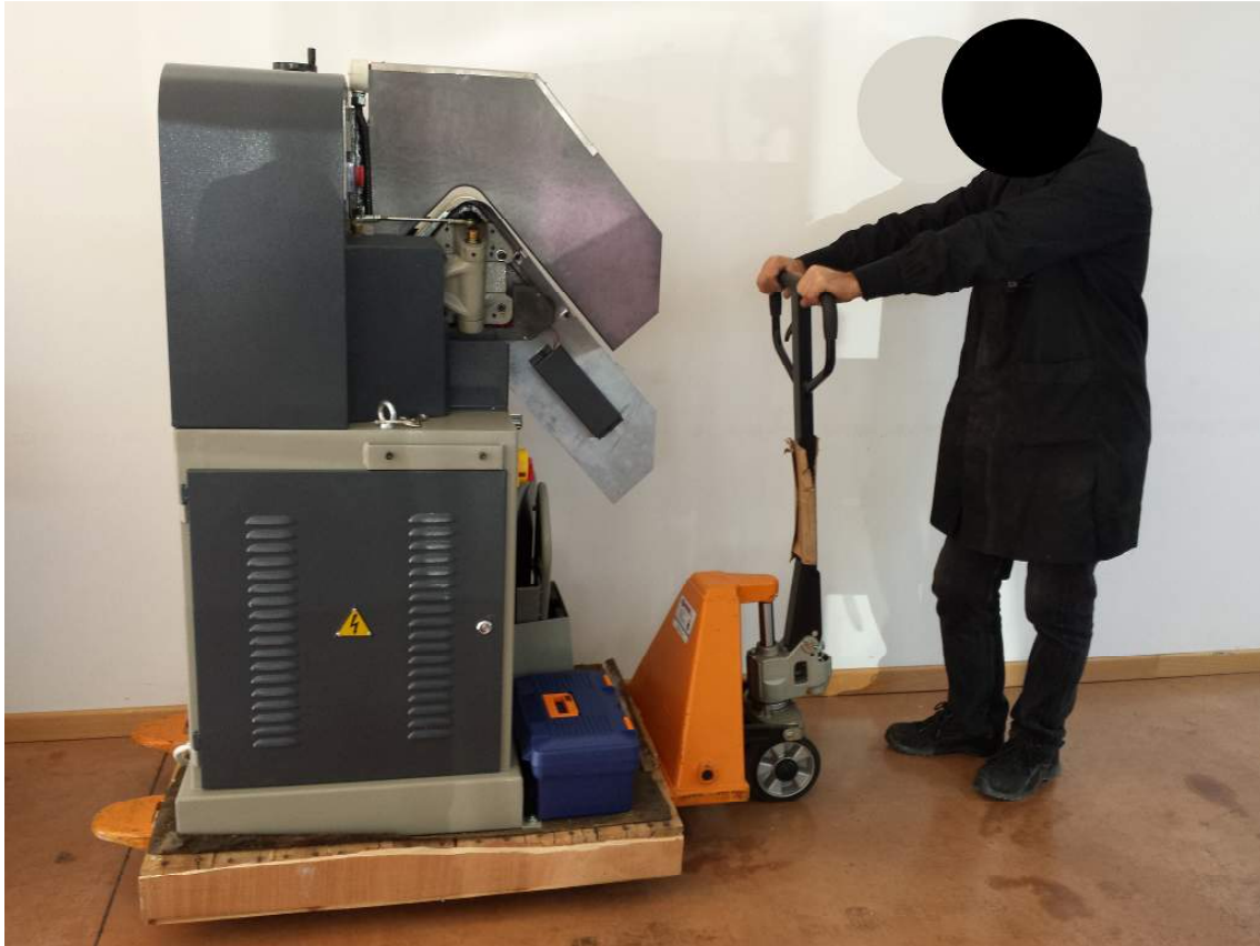
Figura 16 – Movimentazione con carrello manuale
