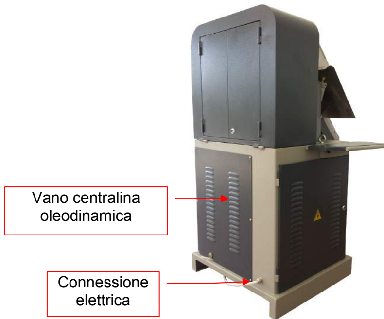
Figura 6 - Vista generale posteriore
