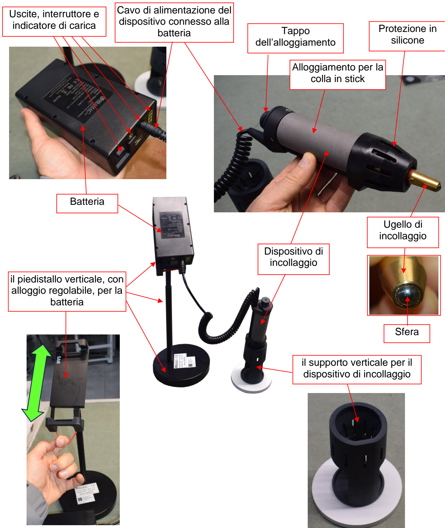
Figura 1 - Vista dell'APPLICATORE ADESIVI HOT-MELT e suoi dettagli
