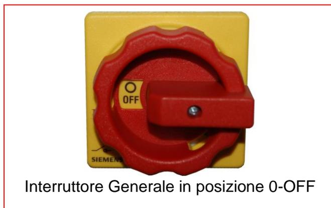
L'interruttore è munito di un'asola che è attiva con lo stesso in posizione 0-OFF. L'asola consente di bloccare l'interruttore meccanicamente, tramite un lucchetto; questa operazione viene eseguita per effettuare la manutenzione o per inibire l'uso della macchina. L'asola è visibile direttamente (in figura).
