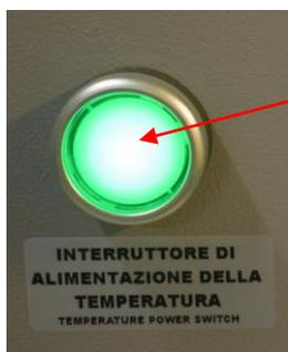
Spegnere il riscaldamento della dima superiore, premendo il pulsante lampada verde INTERRUTTORE DI ALIMENTAZIONE DELLA TEMPERATURA, che si spegne
