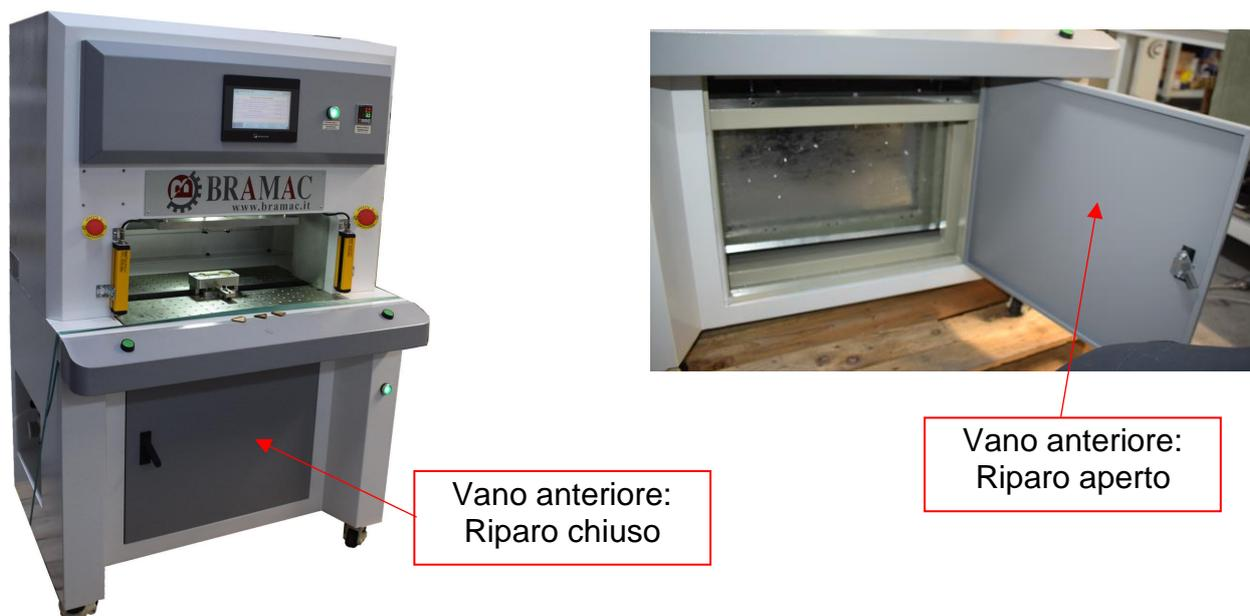
**Figura 10 - Ripari mobili: sportello apribile del vano anteriore**
