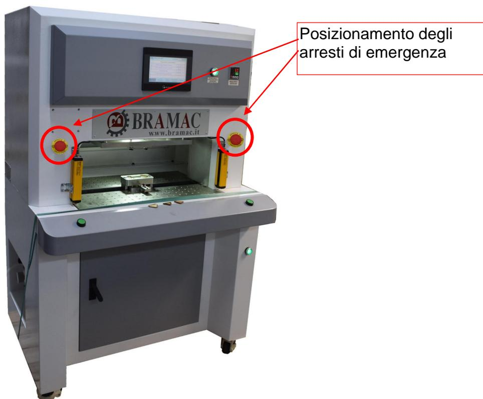
**Figura 20 – Posizionamento degli arresti di emergenza**
